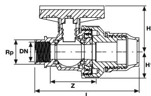
**U-PVC ONE SIDE MALE THREADED ONE SIDE COMPRESSION OUTLET SINGLE UNION BALL VALVE**
