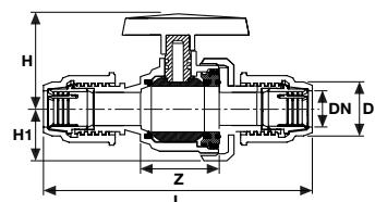
**U-PVC ONE SIDE FEMALE THREADED ONE SIDE COMPRESSION OUTLET SINGLE UNION BALL VALVE**
